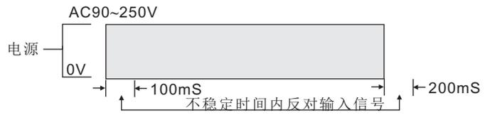
注意电源上电  $\sim$  内电压上升和电源关闭  $\sim$  内电压下降时间范围
